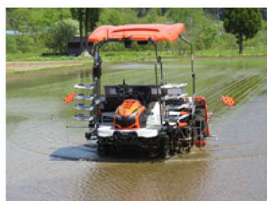
ロボット田植機による田植え作業
