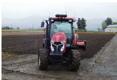
ロボットトラクターによる耕起作業
